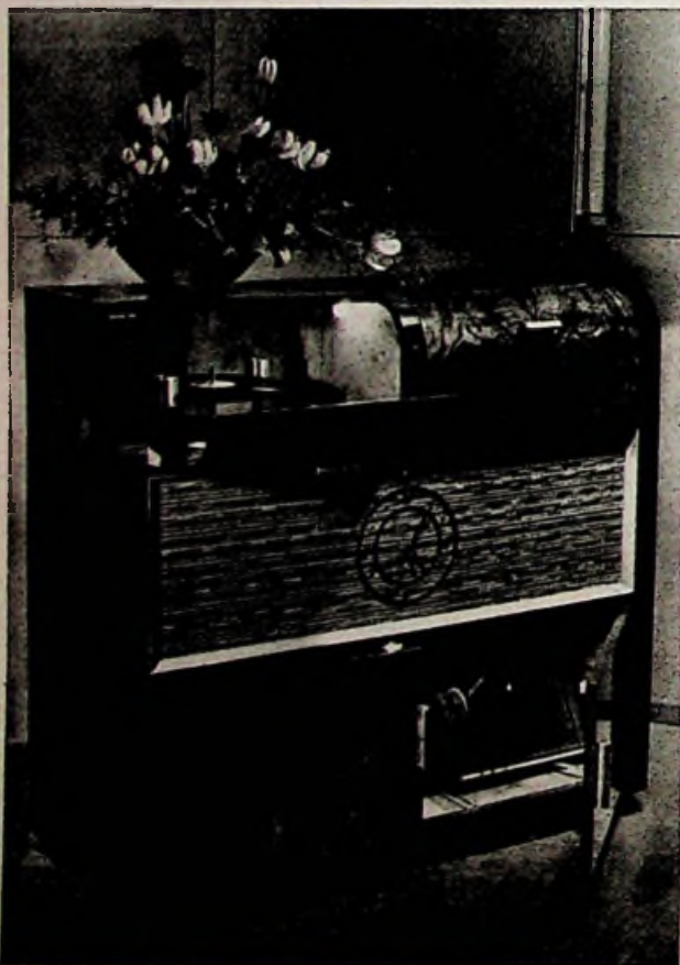
Eine geschmackvolle Musiktube mit einem 6-Röhren-6-Kreis-Spitzen-Super mit dreifach gespreiztem KW-Teil, eingebautem Einfach- oder Zehnplattenwechsler der Firma Juschka, Eisenach
