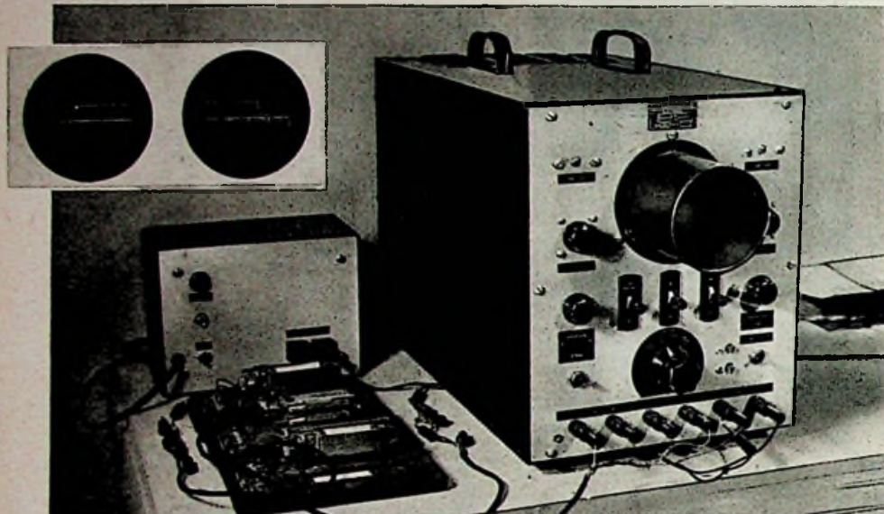
Kurzzeitmeßgerät der RFT Arnstadt zur Sichtbarmachung von Schaltvorgängen und zur Messung der Schaltzeiten. Im Schirm der Braunschen Röhre wird elektrisch eine Zeitmarke erzeugt, die einen Vergleich und ein unmittelbares Ablesen des zeitlichen Verlaufes der Schaltvorgänge gestattet. Das Gerät hat zwei Meßbereiche, und zwar für 40 \mu sec und 4 \mu sec. Das zu untersuchende Relais wird durch eine besondere Vorrichtung in einem festgelegten Rhythmus an- und abgeschaltet. Die beiden Aufnahmen zeigen links den Einstell- und rechts den Abstellvorgang
