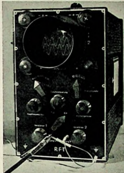
Zweistrahloszillograf Typ OG 2/6C. Der nutzbare Schirmdurchmesser der Röhre beträgt 100 mm, die Ablenkgeschwindigkeit etwa 0,5 mm/V
